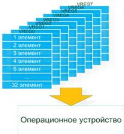
Рисунок 1 Схема процессорной ячейки матрично-векторного сопроцессора
